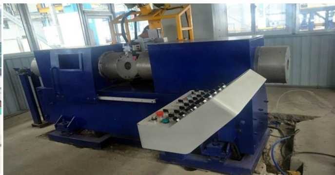
大型管管对接设备
