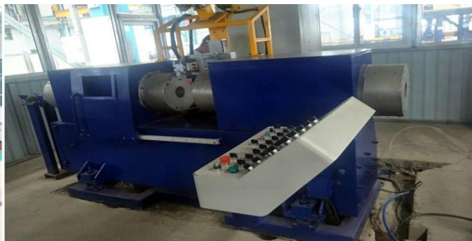
大型管管对接设备
